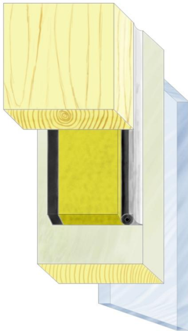
Figur 8. Tätning mellan väggregel och fönsterkarm för vägg D. Utifrån och in (vänster till höger) är det expanderande fogband, drevning, bottningslist och fogmassa.
